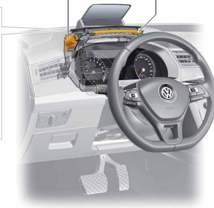
Schalttafelklappe des Head-up-Displays
