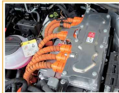
Leistungs- und Steuerelektronik für Elektroantrieb JX1
