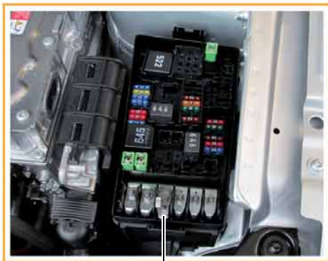
Elektromodulbox mit Relais- und Sicherungshalter SB und Multifuse-Vorsicherungshalter SA
