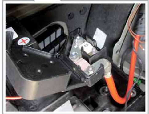
Sicherung (200 A) am Pluspol der 12-Volt-Fahrzeuggatterie
