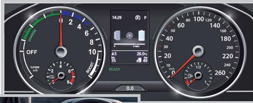
Schalttafeleinsatz mit GTE-spezifischen Anzeigen
